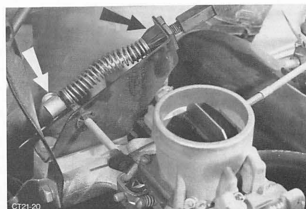
Abb. 188 Gaszug am Gasgestänge einhängen und befestigen
