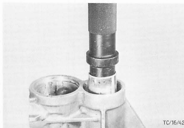
Abb. 114 Büchse – Getriebeverlängerung mit Spezialwerkzeug 16-014 einbauen
