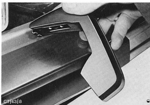
Abb. 19 Klemmhaken des Stoßfängerhorns hinter den Stoßfängerrand einhängen.
