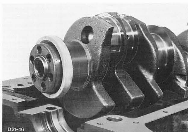
Abb. 144 Kurbelwelle aus dem Zylinderblock heben
