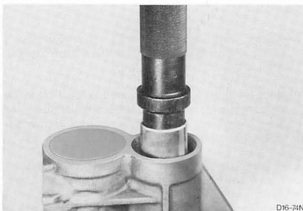
Abb. 126 Büchse – Getriebeverlängerung mit Spezialwerkzeug 16-015 eintreiben („B“-Getriebe)
