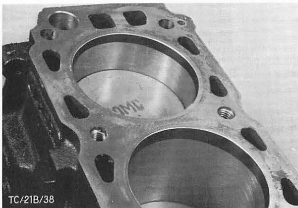
Abb. 88 Ölkohlekranz am oberen Zylinderrand entfernen
