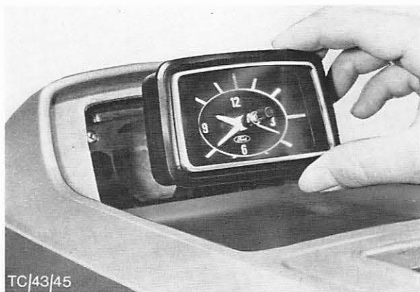
Abb. 59 Uhr in die Aufnahme der Konsole einsetzen.
