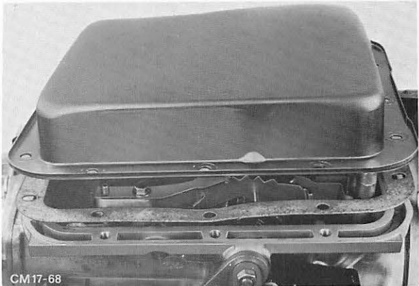
Abb. 115 Ölwanne mit neuer Dichtung montieren
