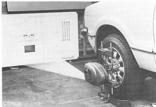
Abb. 57 Optoflex-Gerät zeigt den Gesamtspurwert an
