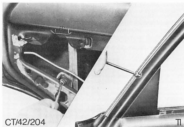
Abb. 7 Befestigungsschrauben der Mittelstrebe – Fensterrahmen
