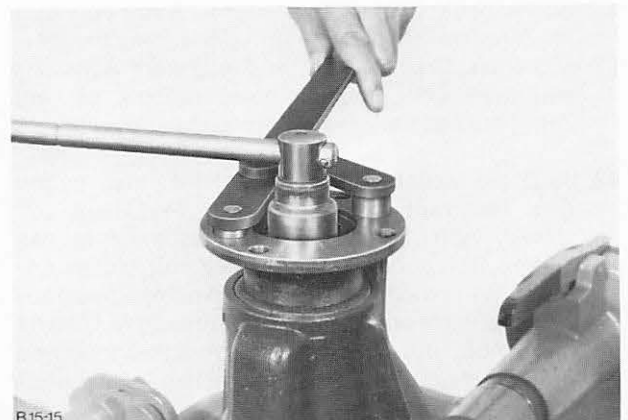
Abb. 85 Flansch – Antriebskegelrad festhalten und Mutter langsam festziehen
