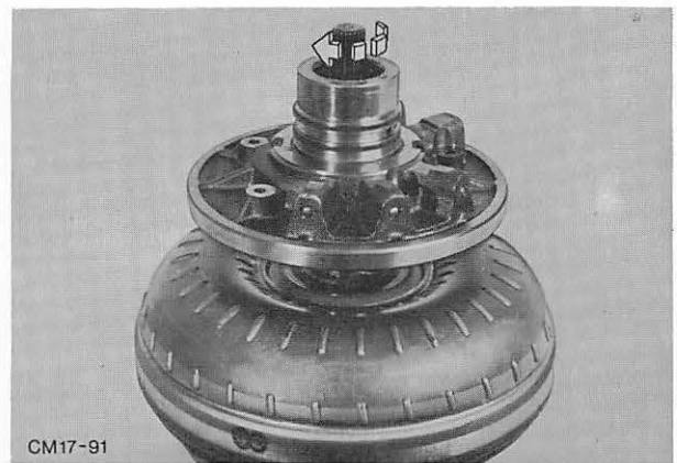
Abb. 13 Kontakt Leitrad (Stator) zur Turbine prüfen
