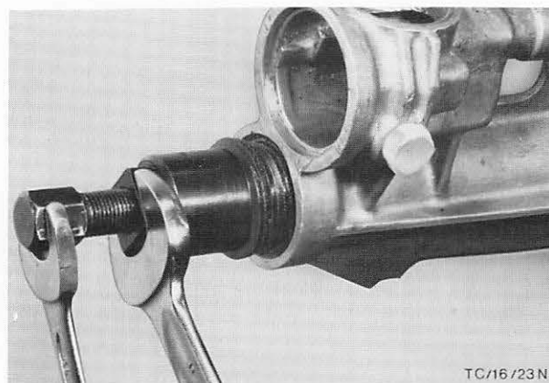
Abb. 34 Radialdichtring mit Spezialwerkzeug 16-007 ausbauen
