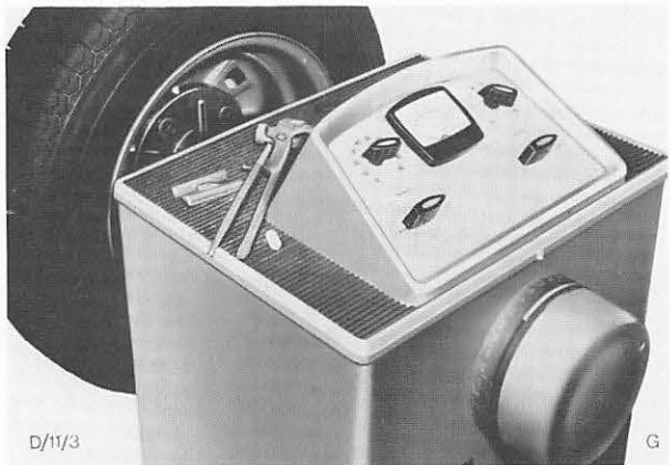
Abb. 5 Typische stationäre Auswuchtmaschine
