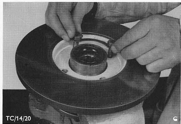
Abb. 21 Schrauben und Sicherungsbleche entfernen
