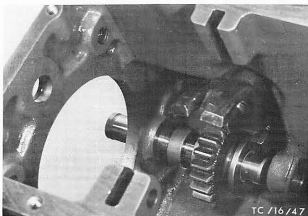
Abb. 58 Zwischenrad Rückwärtsgang einbauen
