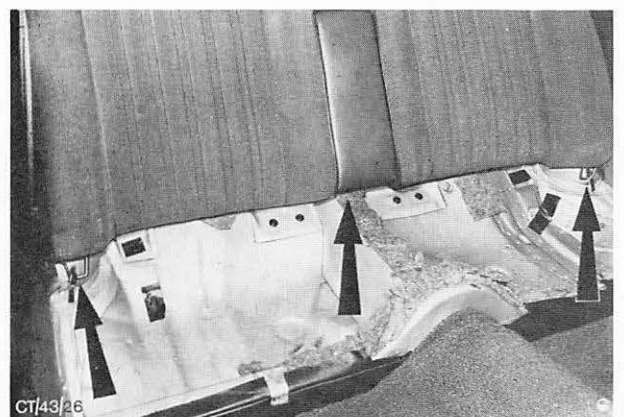
Abb. 45 Die Haltelaschen (Pfeile) der Hintersitzlehne werden nach Ausbau des Hintersitzkissens zugänglich.
