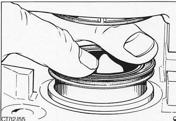
Abb. 31 Kolben in die Bremssattelbohrung eindrücken
