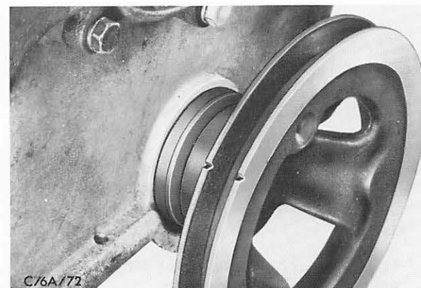
Abb. 164 Stirnraddeckel mit Spezialwerkzeug G3-6059 und Kurbelwellen-Riemenscheibe zentrieren
