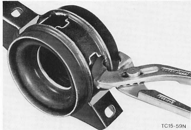
Abb. 123 Blechzungen (6) über die Gummiwulst biegen
