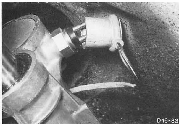
Abb. 17 Kabel – Rückfahrscheinwerfer anschließen
