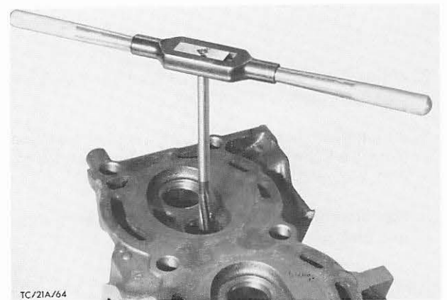
Abb. 250 Ventilfehrung aufreiben, „C“-Motor
