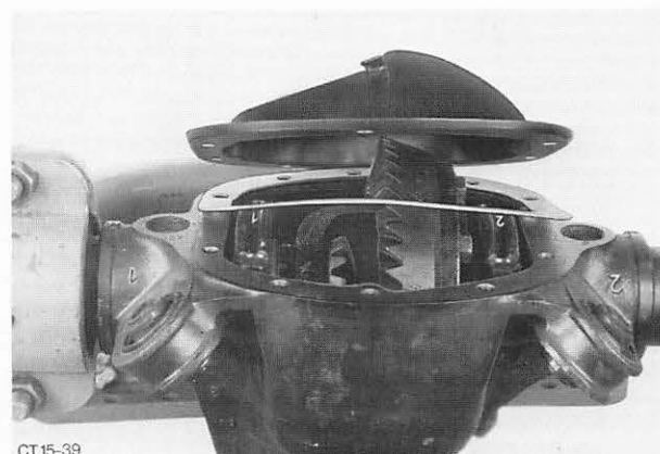
Abb. 98 Deckel mit neuer Dichtung montieren
