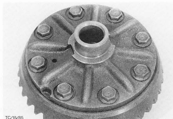
Abb. 58 Befestigung – Tellerrad an Ausgleichgetriebegehäuse
