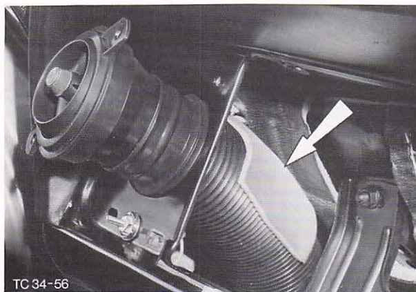
Abb. 55 Schlauch mit aufgeklebtem Dämpfungsmaterial
