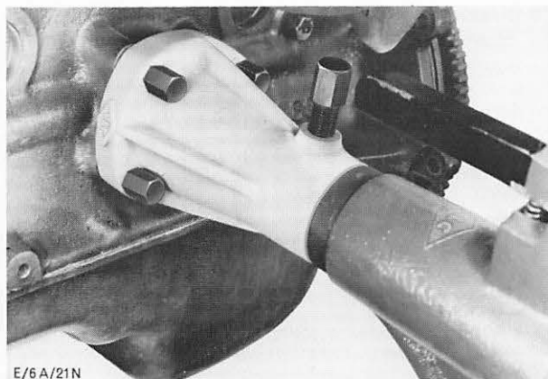
Abb. 30 Motor mit Aufspannvorrichtung 21-031 am Montage- geständer befestigen
