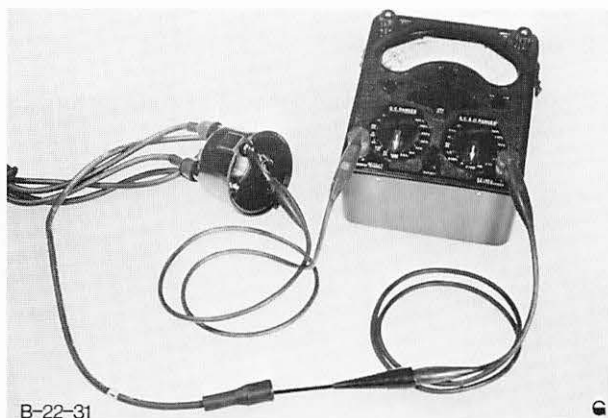
Abb. 34 Zündkabel auf Durchgang prüfen
