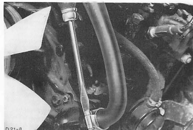
Abb. 15 Heißwasserschlauch an Wasserstutzen montieren, „C“-Motor
