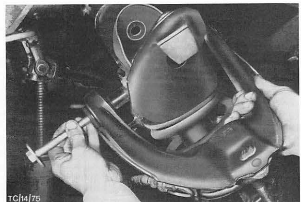
Abb. 32 Herausnehmen der Schraube im oberen Querlenker
