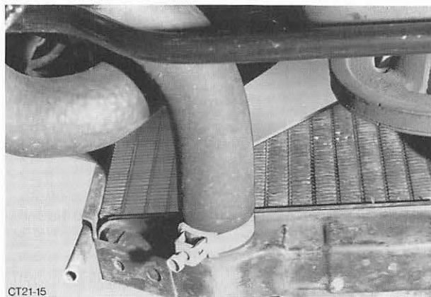
Abb. 203 Kühlerschlauch vom Kühler trennen
