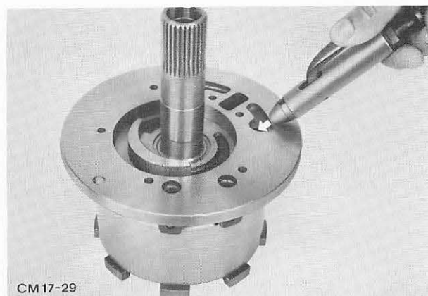
Abb. 66 Hydraulikkolben mit Hilfe von Druckluft ausbauen
