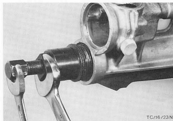
Abb. 84 Radialdichtring mit Spezialwerkzeug 16-006 ausbauen
