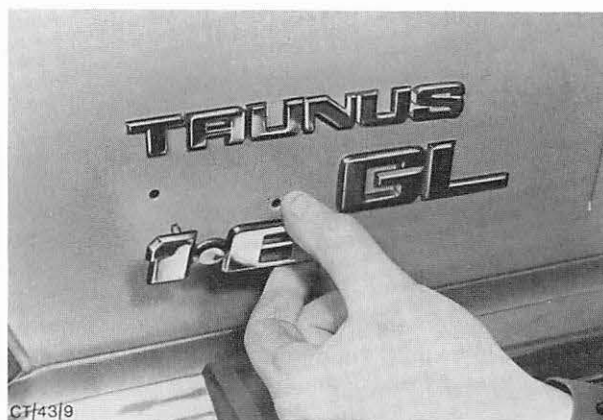
Abb. 13 Haltestifte der Buchstaben in die entsprechenden Löcher im Rückwandblech einführen.
