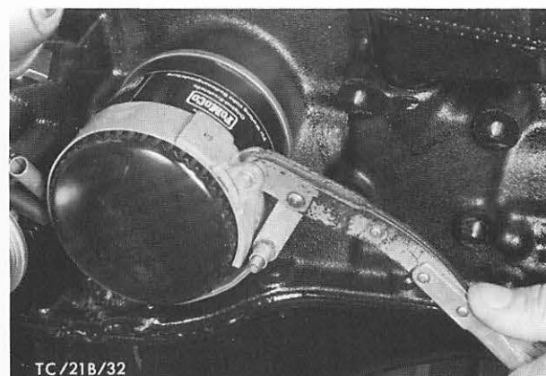
Abb. 80 Ölfilter mit Spezialwerkzeug GV-6883 abschrauben
