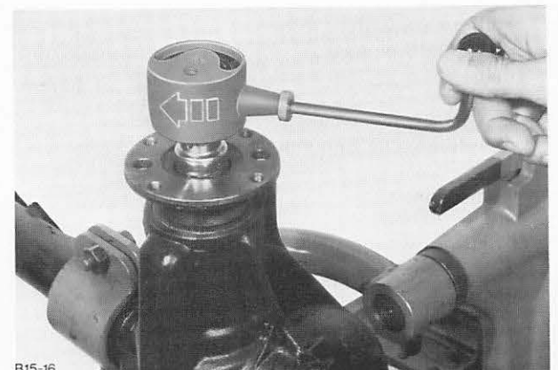
Abb. 86 Durchdrehmoment des Antriebskegelrades prüfen
