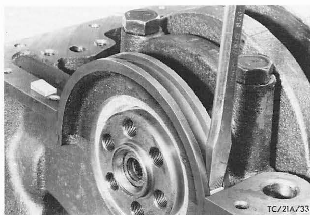
Abb. 157 Dichtkeile hinterer Hauptlagerdeckel mit einem stumpfen Schraubenzieher montieren
