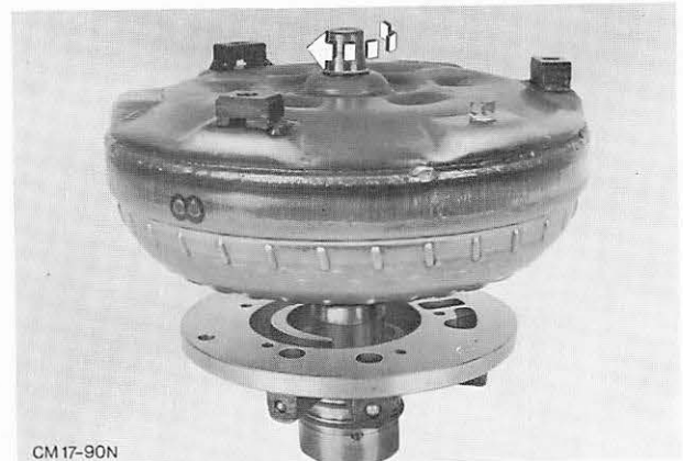
Abb. 12 Kontakt Turbinenrad zum Leitrad (Stator) und zur Pumpenschale prüfen
