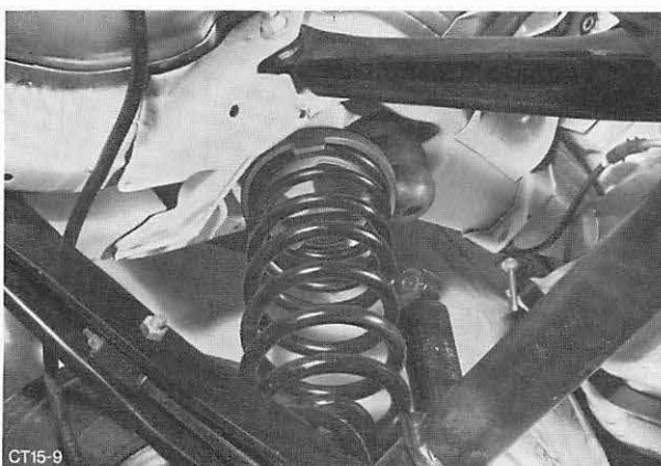
Abb. 12 Schraubenfedern mit Gummiauflage montieren
