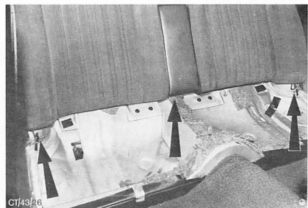
Abb. 53 Die Haltelaschen (Pfeile) der Hintersitzlehne werden nach Ausbau des Hintersitzkissens zugänglich.
