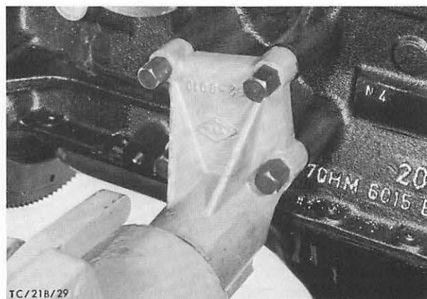
Abb. 79 Motor mit Aufspannvorrichtung 21-031 am Montageständer befestigen
