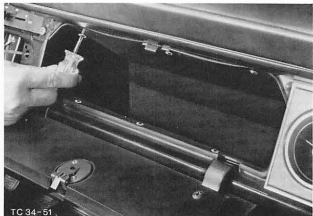
Abb. 29 Befestigungsschrauben des Handschuhkastens herausdrehen.
