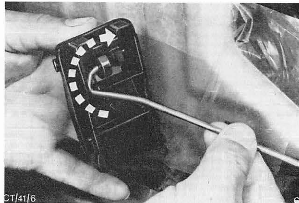
Abb. 40 Türöffnungshebel innen von der Fernbetätigungsstange aushängen.
