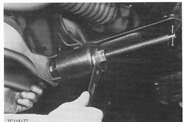
Abb. 21 Büchse mit Werkzeug 14-004 montieren
