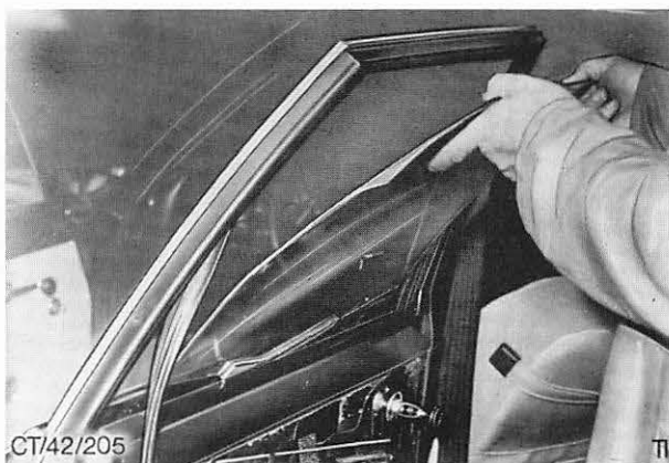
Abb. 8 Ausbau der Fensterscheibe aus der hinteren Tür. Beachte: Scheibe muß zum Innenraum hin herausgenommen werden.
