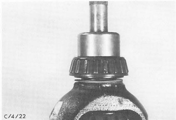
Abb. 93 Kegelrollenlager auf Ausgleichgetriebegehäuse pressen
