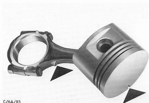
Abb. 311 Anordnung der Frontmarke und Spritzbohrung zueinander
