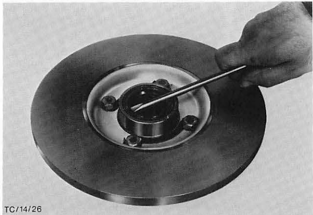
Abb. 64 Radialdichtring der Vorderradnabe herausheben
