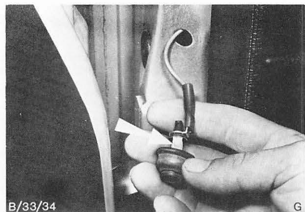
Abb. 63 Ausbau des Türschalters
