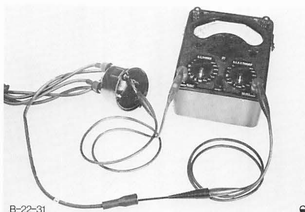
Abb. 11 Zündkabel auf Durchgang prüfen (AVO Ohmmeter gezeigt)
