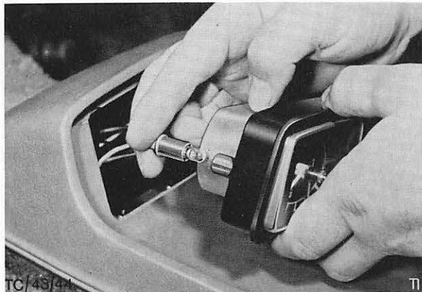
Abb. 58 Glühlampe der Zeituhrbeleuchtung einsetzen.
