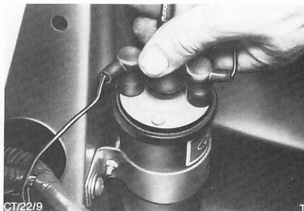
Abb. 10 Abklemmen des Zündkabels von der Zündspule. Am Kabelstecker, nicht aber am Kabel ziehen!
