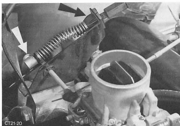
Abb. 181 Gaszug am Gasgestänge aushängen und vom Halter abbauen
