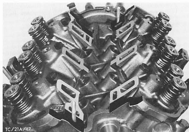
Abb. 174 Dichtflächen-Außenkante an Zylinderköpfen mit Dichtmasse bestreichen
