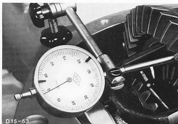
Abb. 89 Taststift der Meßuhr auf inneren Tellerradbund setzen
