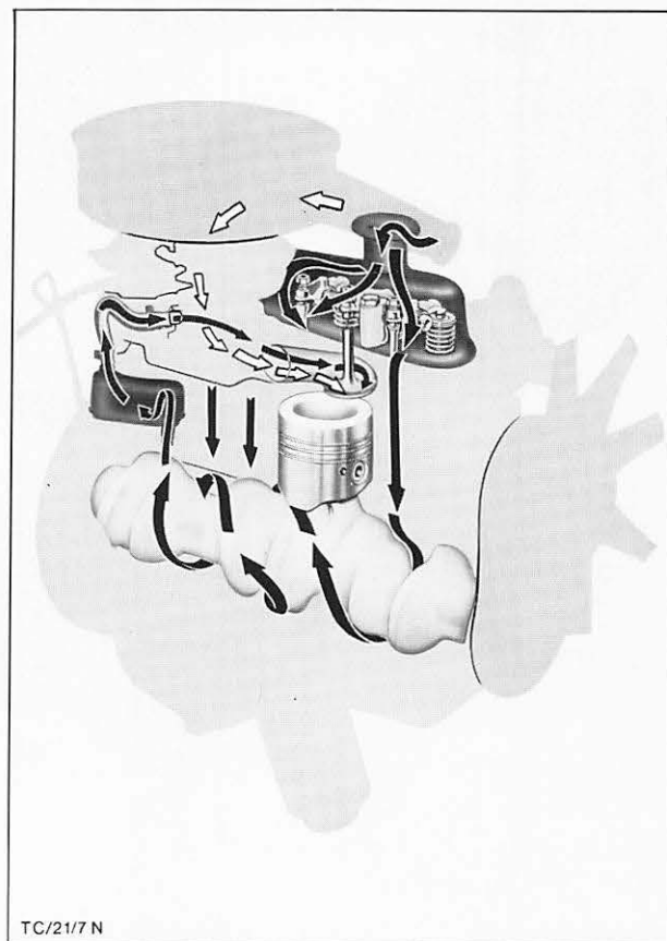
Abb. 29 Geschlossene Motordurchlüftung
