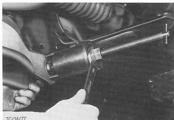
Abb. 42 Innere Büchse mit Werkzeug 14-004 herausziehen
