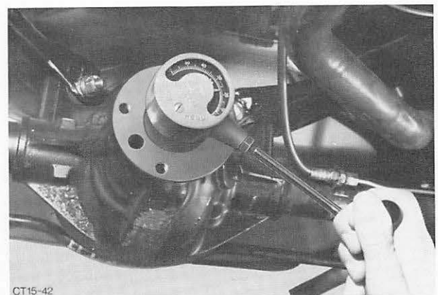
Abb. 104 Durchdrehmoment der Achse am Antriebskegelrad prüfen
