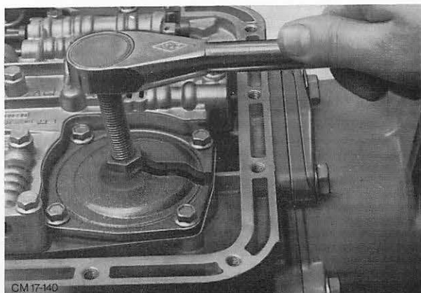
Abb. 110 Einstellschraube mit Werkzeug 17-005 einstellen
